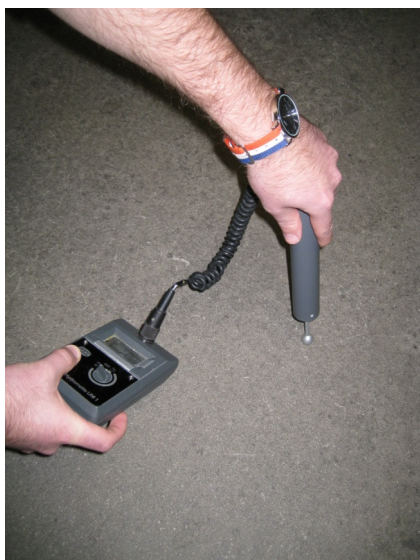
Figur 8 Kontroll av RF i betong
